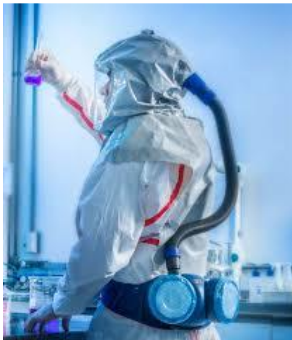
Figura 14: EPR purificador de ar motorizado com cobertura das vias respiratórias tipo “capuz”.
